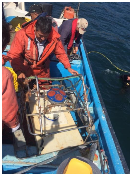
Figura 13. Maniobra de fondeo/desfondeo a de los ADCP.
