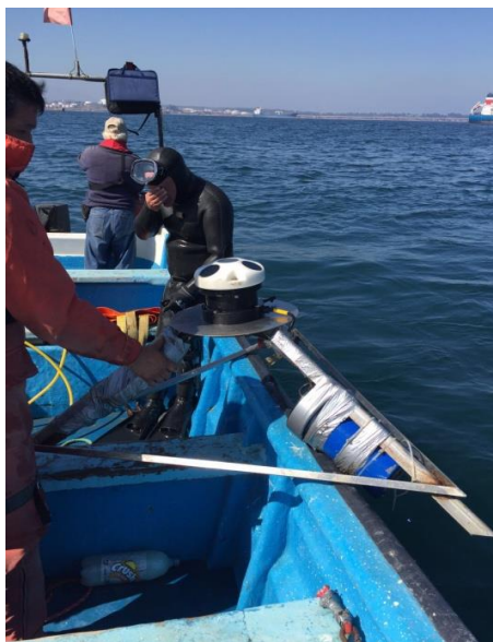
Figura 13. Maniobra de fondeo/desfondeo a de los ADCP.
